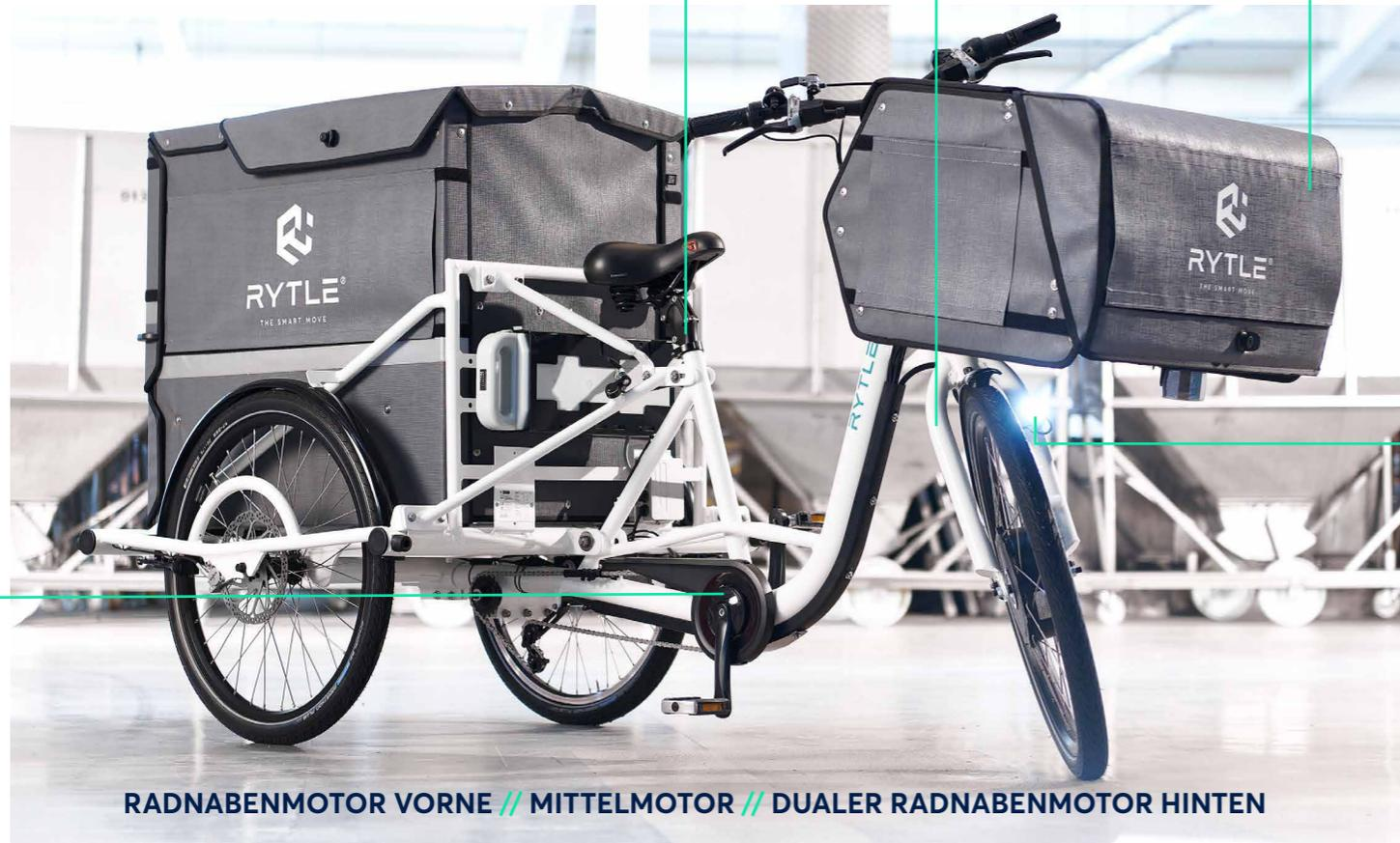
RADNABENMOTOR VORNE // MITTELMOTOR // DUALER RADNABENMOTOR HINTEN
